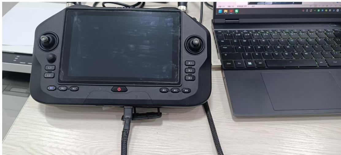
2. 遥控器屏幕弹出一个：检测到 TypeC 插入是否关闭视频显示，开启 TYPEC 文件传输，选择确定 1
