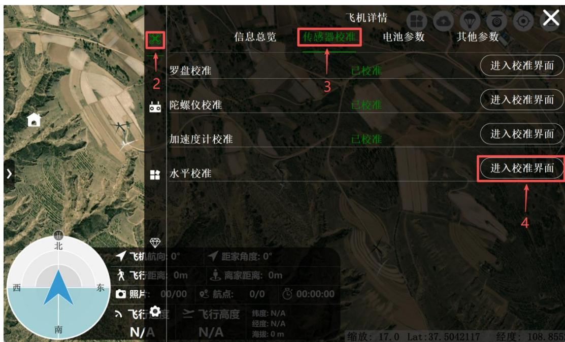
4.无人机静置 3 分钟以上后，点击 5 开始，无人机开始自己校准水平，校准过程中无人机禁止移动，等校准进度完成，飞机图标显示绿色，无人机播报水平校准成功就完成了校准。
