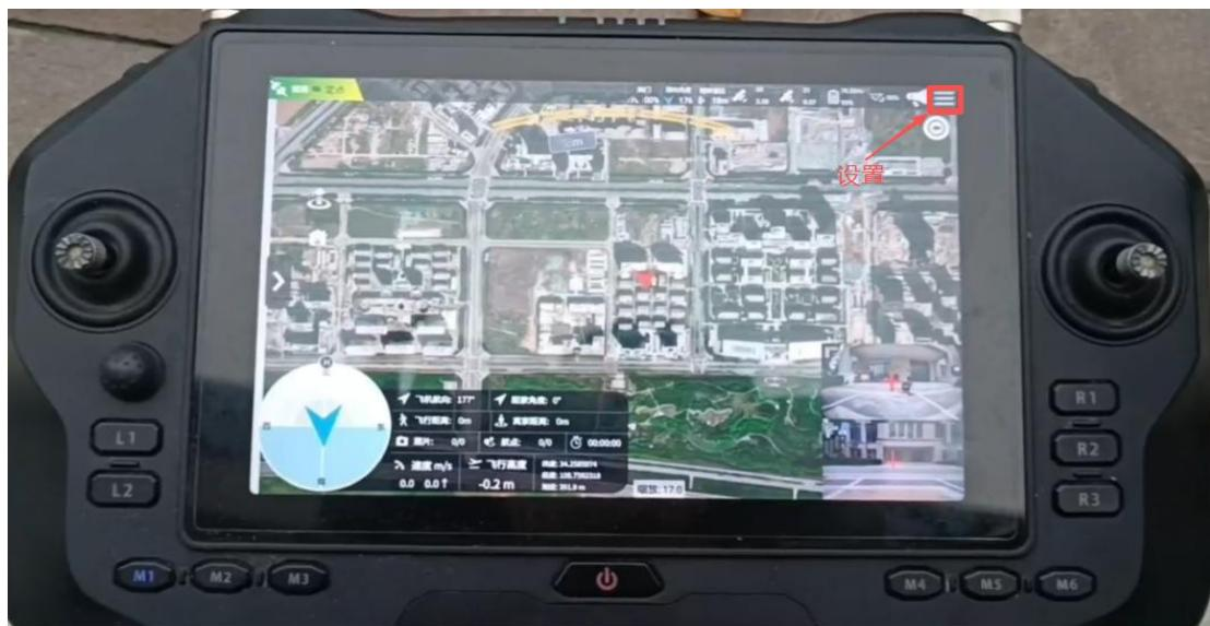
2.先点击无人机设置 1，进入飞机详情界面，点击传感器校准 2，再点击罗盘校准 3
